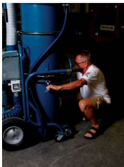
Behållaren sätts fast på maskinen med hjälp av de båda spärrläsen.
